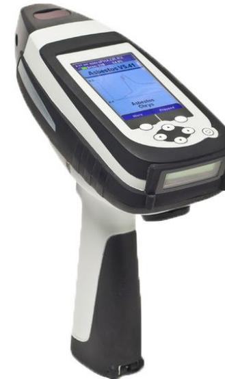
*Le détecteur d'amiante portable MicroPHAZIR identifie 3 types de fibre d'amiante réglementaires (Chrysotile, Amosite, Crocidolite) en utilisant un algorithme de comparaison des spectres enregistrés dans sa mémoire interne. Si l'une de ces formes minérales est identifiée, l'appareil l'affiche sur l'écran. Le MicroPHAZIR Amiante permet, sur la base de prélèvements précédemment réalisés, de cartographier les éléments amiantés sans prélèvements complémentaires.*
